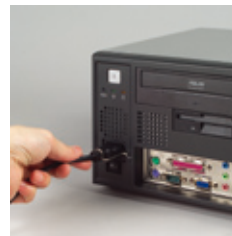
电源插头固定栓防止电源接头的脱落
