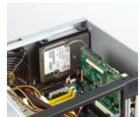
具有抗振性设计的磁盘驱动器
