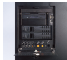
一个超薄CD-ROM驱动器，两个3.5" 磁盘驱动器和两个移动式SATA HDD托架
